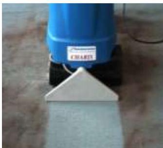
De cette façon **l'utilisation d'eau** se réduit jusqu'à un quart par rapport au système injection-extraction de base. En plus le système d'aspiration à haute dépression permet de récupérer un pourcentage d'eau supérieur par rapport aux autres machines à extraction traditionnelles (90% environ contre 80%).
