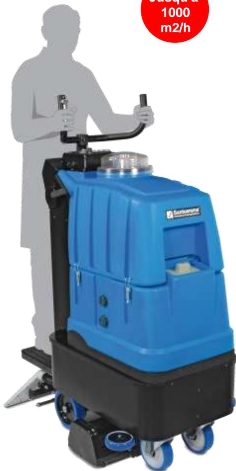
**Nikita** est un nettoyeur moquette autoporté, idéal pour des surfaces de moquette très étendues, qui permet de nettoyer jusqu'à 1000 m<sup>2</sup> de moquette en une heure. En un seul passage, une bande de 70 cm de moquette est pulvérisée avec une solution concentrée de produit chimique, broyée par deux brosses contrarotatives, rincée et aspirée.
